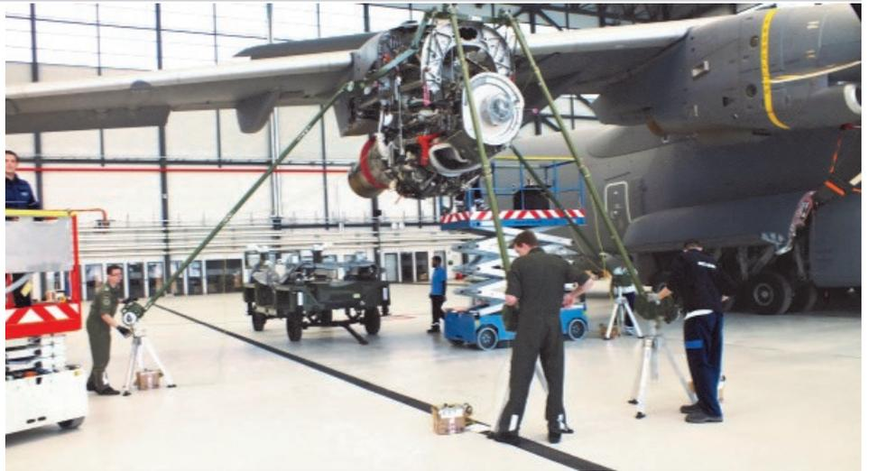
**Ausbau des Triebwerks mit Hilfe des Multi Task AGE.**
