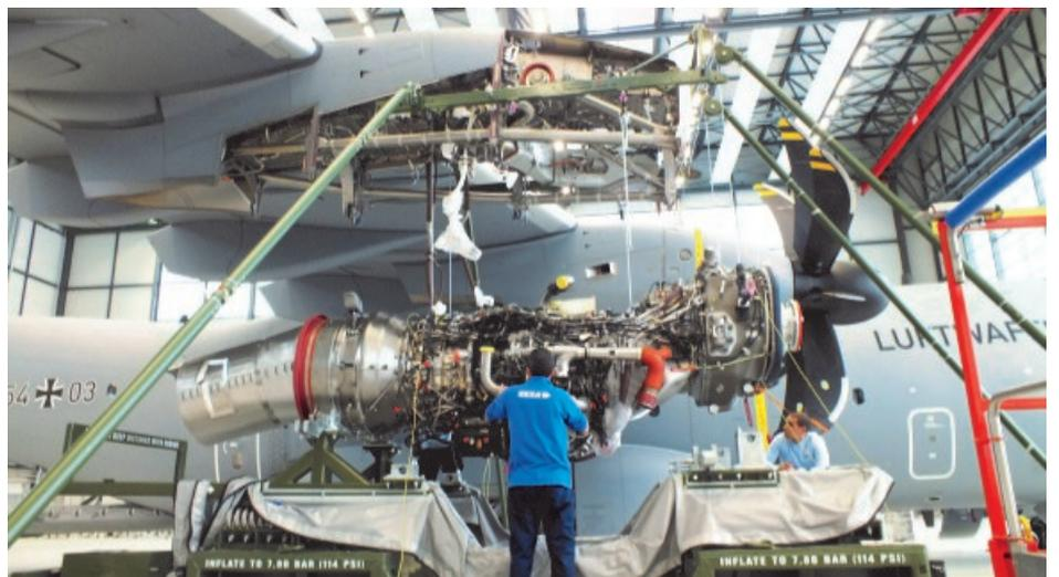
**Ausbau des Triebwerks und anschließende Montage auf dem Engine FOS Trailer.**
