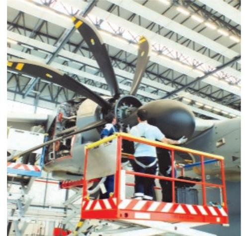
**Demontage von Anbauteilen und Cowling.**
