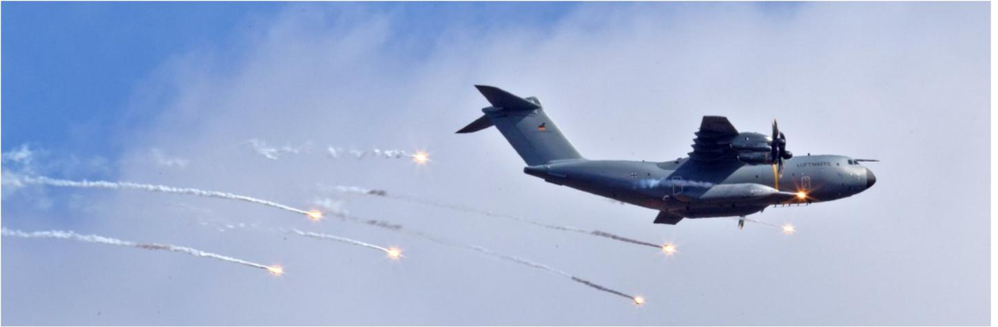
In Wunstorf ist der erste A400M mit der Selbstschutzanlage DASS angekommen. Die ersten Techniker sind bereits im Umgang mit dem Defensive Aids Sub – System ausgebildet. Auf dem Übungsgelände der Wehrtechnischen Dienststelle hat der Transportflieger auch die ersten Erprobungsflüge mit dem Verschleßen von Scheinzielen hinter sich.
