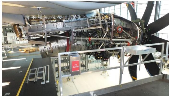
**Triebwerk seitlich ohne Abdeckung.**
