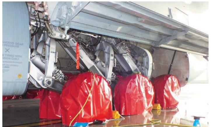
Hierfür gibt es spezielle Abdeckungen und Schutzfolien, die einzeln angebracht werden. Insgesamt sind es über 120 Stellen, die extra vorbereitet werden müssen.
