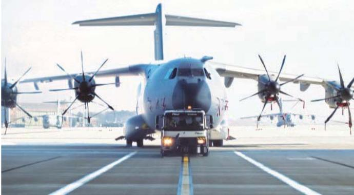
**Fast 80 Tonnen hängen am Haken des Schleppfahrzeuges.**
