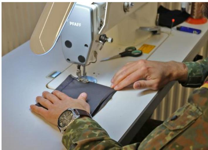
Die fertig zugeschnittenen Stoffe, das Schutzfließ, der Draht zum andrücken an die Nase und die Gummibänder zum Tragen, werden an der Nähmaschine zusammengenäht.
