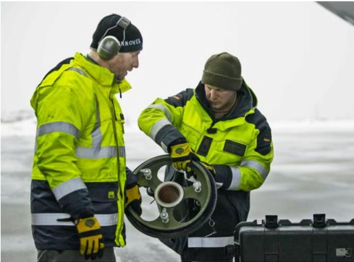
Die beiden Techniker bereiten sich auf den Reifenwechsel vor. Ihr erstes Werkzeug: das Wheel Removal and Installation Tool.
