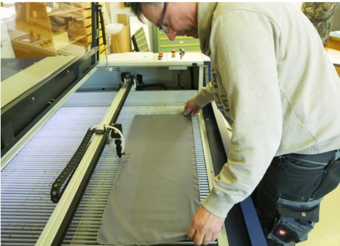
Im Laserplotter können viele Stoffbahnen übereinandergelegt und gleichzeitig in Form gebracht werden. Mit der altbewährten Schere undenkbar.
