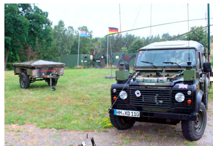
Der Landrover von Rainer Preuß, Baujahr 1997 – Typ Defender Wolf XD 2,5l TDI ist ausgestattet mit Funkgeräten der Fa. Clansman für UKW und Kurzwelle und war zuletzt 2021 in Sennelager für die britische Armee im Einsatz.
