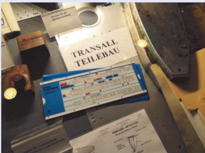
Für die Bauteile wurden Stempel und Formen angefertigt, um für die Serie eine identische Ausführung zu gewährleisten.
