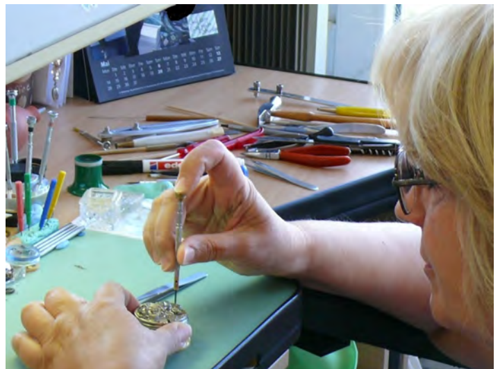
Feinmechanische Fliegeruhren werden in der einzigen Uhrenwerkstatt der Bundeswehr funktionsfähig gehalten.
