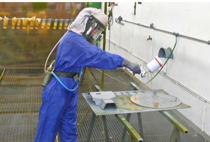
Nach einer Fertigung oder Instandsetzung werden Bauteile bis hin zum Großgerät mit Korrosionsschutz und Schutzlack versehen.
