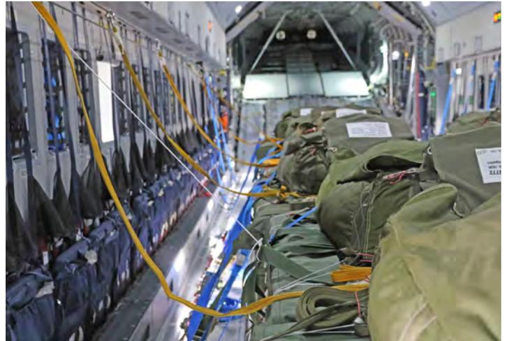
**Die angebrachten Leinen lösen den Fallschirm automatisch aus.**
